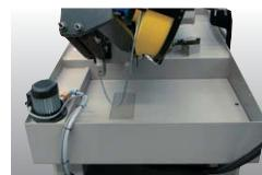
■ Vasca refrigerante da 40 l integrata nella parte superiore del basamento, facilmente accessibile per la pulizia e il riempimento, con tappo di scarico.
