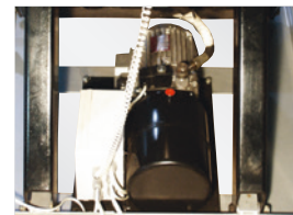
Pumpenhet med låg ljudnivå med inbyggd överlast- och flödekomparerad ventil för kontrollerad sänkhastighet.
